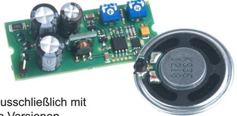
Befestigen Sie das Modul in der Lokomotive mit Schrauben in den Aussparungen auf der kurzen Seite der gedruckten Schaltung, oder kleben Sie diese mit doppelseitigem Klebeband an die entsprechende Stelle. Die Unterseite des Moduls muss mit Isolierband versehen werden, damit sich die leitenden Teile des Modells nicht berühren.
